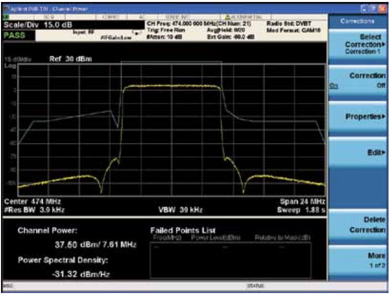
Рис. 10. Измерение мощности в канале с помощью представления маски спектра после коррекции амплитуды
