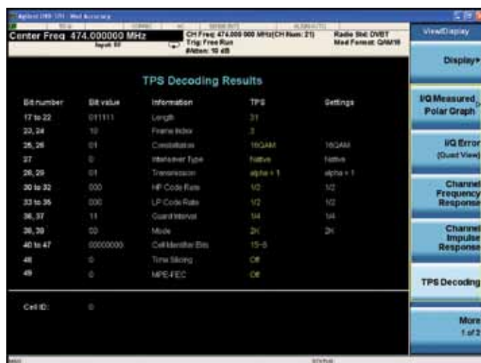
Рис. 20. Измерение точности модуляции с представлением декодирования TPS
