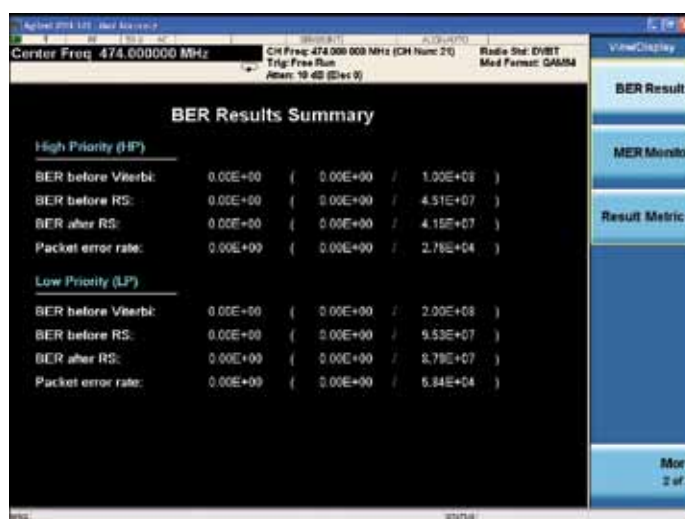
Рис. 21. Измерение точности модуляции с представлением результатов BER
