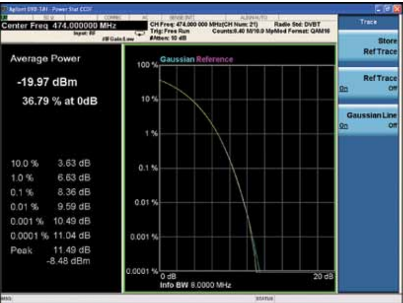
Рис. 13. Измерение комплементарной интегральной функции распределения мощности с эталонной трассой
